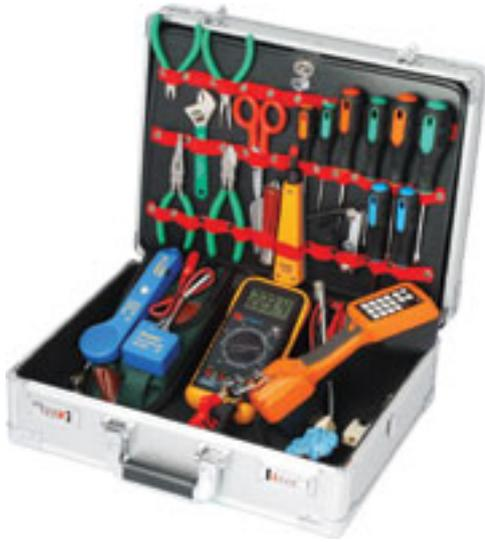
Kompleti šrafcigera, sečica, klješta, ključeva, krimp klješta 4/6/8, tragač kablova (pile), digitalni multimeter, line tester, punch down impact tool, ispitna slušalica sa tastaturom, aluminijumski kofer sa šifrom... zaista veliki broj alata, praktično sve što je potrebno za instalaciju i održavanje i najsloženijih telekomunikacionih mreža
