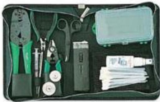
Komplet sadrži sve potrebne alate da bi izvršilo povezivanje ST i SC konektora na fiber optički kabl. Na dnu strane imate veće slike pojedinačnih komponenti.
